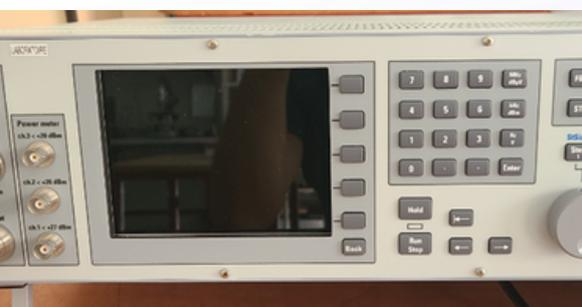
Générateur NSG 4070 permet d'injecter un niveau en tension (10Veff par ex) sur un câble dans la plage de fréquence de 150 KHz à 80 MHz.
