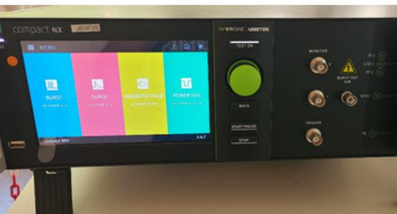
Générateur EMTEST NX COMPACT : permet de générer des salves transitoires (démarrage d'un moteur) et des ondes de chocs (foudres), conformément aux méthodes d'essai décrites dans EN61000 4-4 et EN 61000 4-5.
