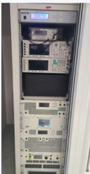
Baie de générateurs et amplificateurs pour l'essai d'immunité aux champs rayonnés
